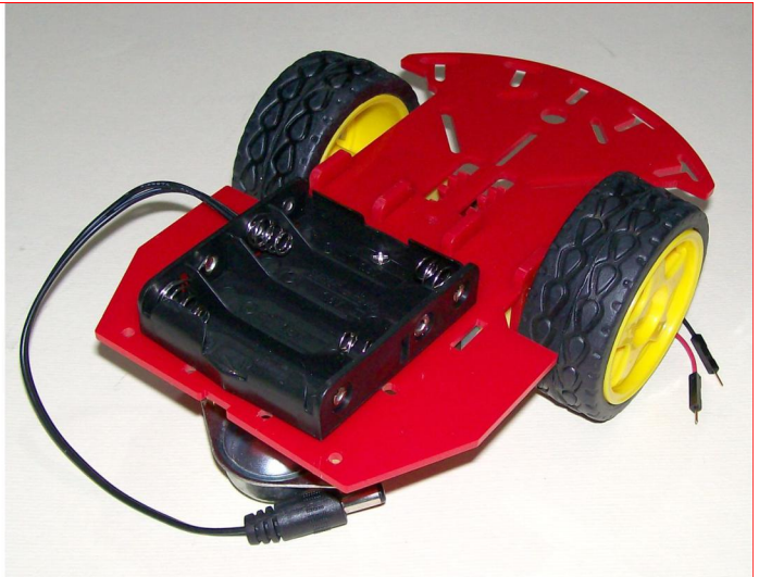
FIGURA 14: INSTALLAZIONE DEL VANO BATTERIE
